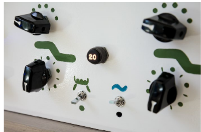
Viel leuchtet nicht - muss es auch nicht. Der CEQ verfügt über einen zuschaltbaren Transformator sowie einen Bypass-Klippschalter. Er kann sowohl "coupled" als "single ended" genutzt werden.
